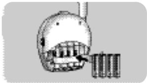
2 Aseta neljä 1,5 V AA -paristoa paristolokeroon niin, että niiden napaisuus vastaa paristolokeron merkintöjä (paristot eivät sisälly toimitukseen; suositellaan Philips Alkaline -paristojen käyttämistä).
